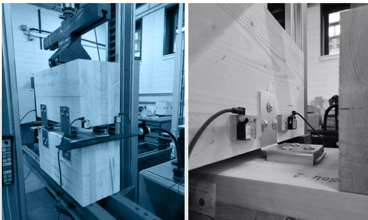
Afbeelding 3 - Mechanische sterkte test van Straviwood Modulink (beugel voor structurele verbindingen) onder druk (linker afbeelding) en Straviwood WallBracket (hoekbeugel voor structurele verbindingen) onder trekspanning (rechter afbeelding).
