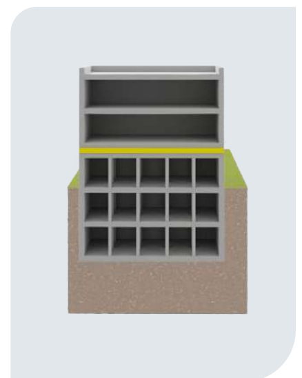
Figure 4.3 - Isolation à partir d'un étage
