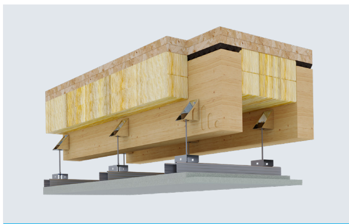
Imagen 5 - Suelo flotante ligero Stravifloor combinado con un falso techo mediante soportes colgantes Stravilink IJH-P.
