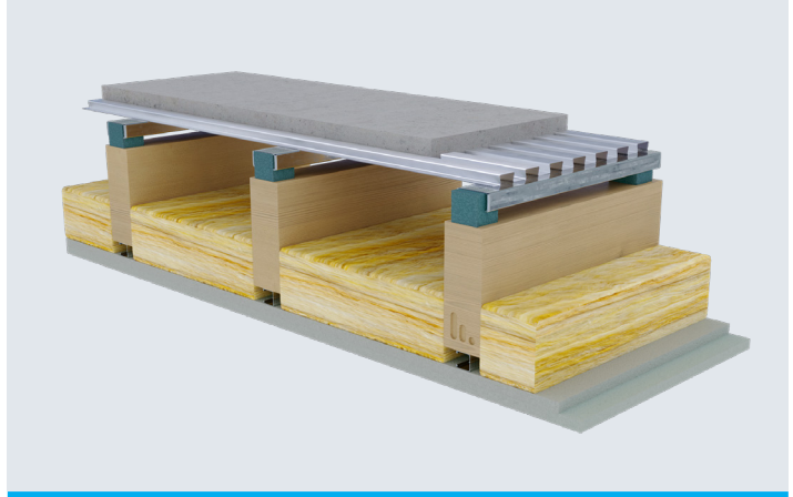
Imagen 4 - Stravifloor Deck sobre viga de madera.
