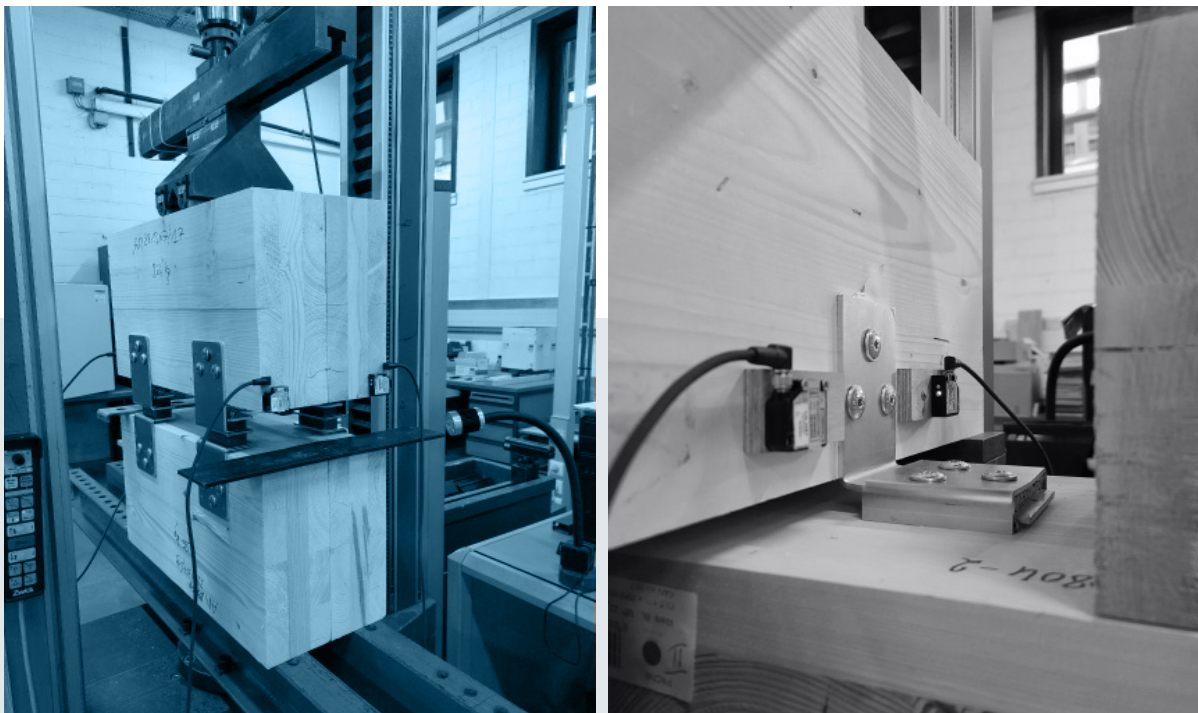
Imagen 3 - Ensayo de resistencia mecánica Straviwood ModuLink (soporte para juntas estructurales) en compresión (imagen izquierda) y Straviwood WallBracket (soporte angular para juntas estructurales) en tracción por elevación (imagen derecha).
