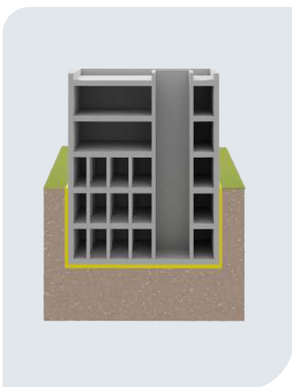
Figura 4.1 - Desacoplamiento de todo el edificio respecto del sustrato o subsuelo
