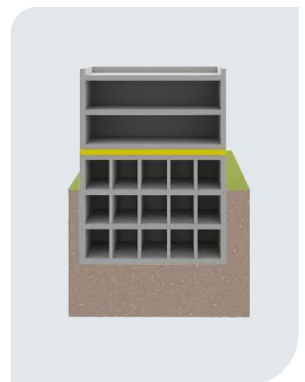
Figure 4.3 - Isolation à partir d'un étage
