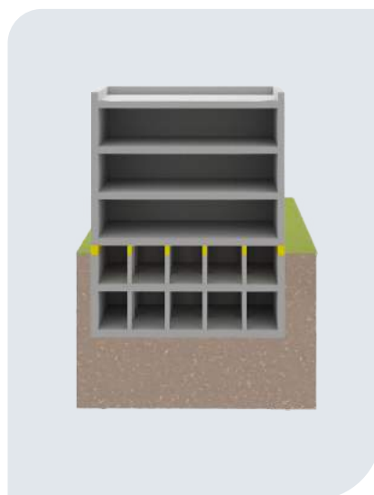
Figure 4.2 - Isolation à partir du niveau rez-de-chaussée
