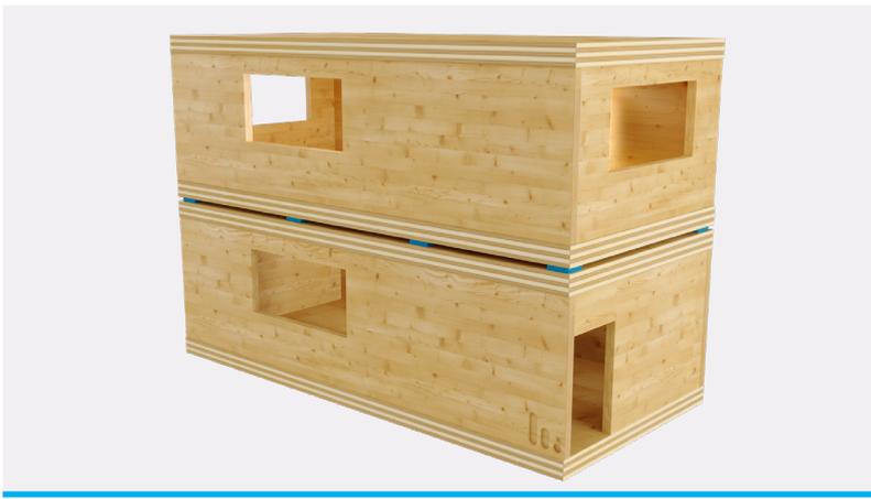
Les [plots résilients, Straviwood ModuBreak](#), ont été spécialement conçus pour découpler acoustiquement les parties empilées des bâtiments modulaires en CLT, en minimisant les transmissions sonores latérales, en améliorant l'isolation des vibrations et du bruit structurel grâce à une diminution du contact rigide entre les modules dans tout le bâtiment.
